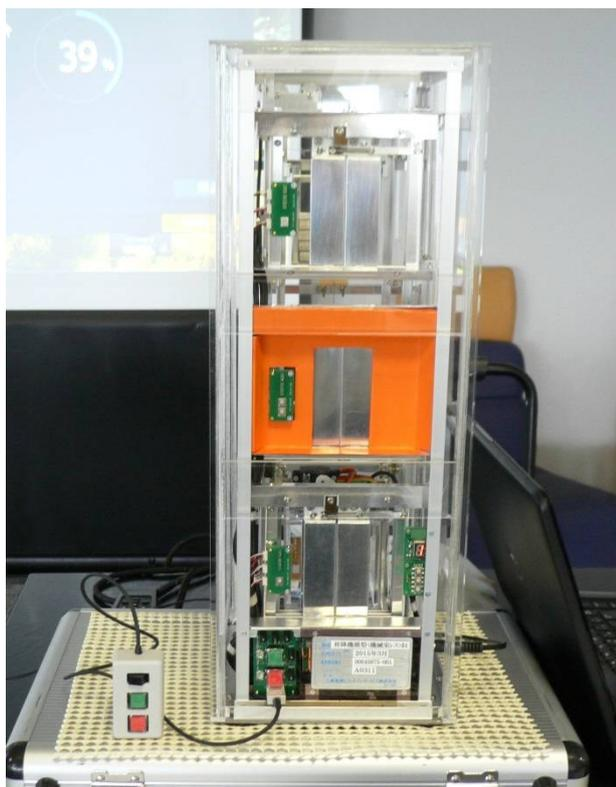
最終バージョンとして、MRL型昇降機模型に新しい機能を追加して2台製作しました。
